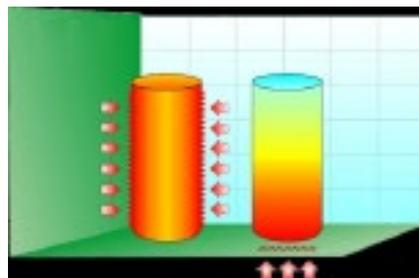
Sus 3 resistencias, distribuidas a lo largo del tubo de descongelado, junto con los 3 sensores, logran un calentamiento uniforme desde la superficie del agua, hasta el fondo del tubo, evitando el choque térmico al introducir la pajuela.
